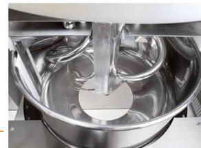
Schnelle Entleerung der Bottiche dank großer Bodenauslassöffnung
